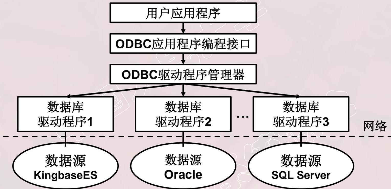
图8.3 ODBC应用系统的体系结构
